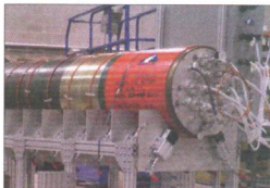
Секция 533-мм АНПА с системой хранения и подачи реагентов к топливным элементам электрохимического генератора (справа)
