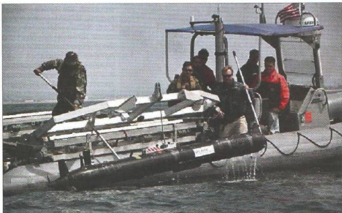
Подводный 324-мм аппарат системы минной разведки Mk 18 Mod. 2 «Кингфиш»
