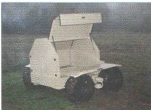
Внешний вид многофункциональной роботизированной (безкипажной) наземной машины TRAKKAR фирмы «Маршалл лэнд системз» (Marshall Land Systems)
